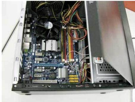
3. 請選擇一個 PCE Express 插槽（較長或較短的插槽均可使用），移除其後方的金屬檔板。
