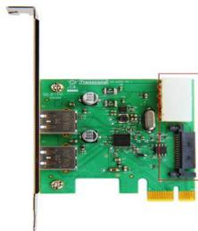
請務必將電腦電源供應線連接到 4-pin or 15-pin 電源連接插頭，以確保能提供 USB3.0 裝置有足夠電力。
