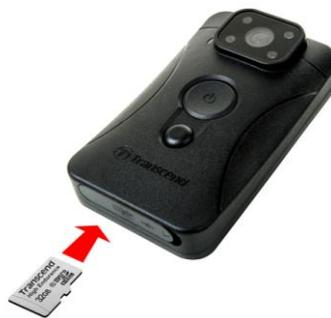
1. Setzen Sie die microSD-Karte in den dafür vorgesehenen Einschub an der unteren Seite der DrivePro Body 10 ein.
